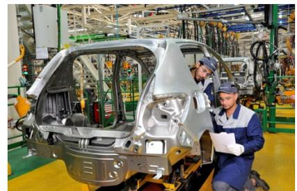
Actemium s'appuie sur le standard AIMS de Renault-Nissan pour l'assemblage des trois segments de la base roulante et pour l'assemblage général des côtés de caisse et du pavillon.
