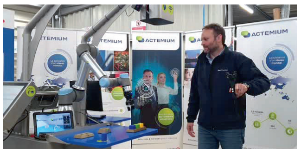
En démonstration, le cobot équipé du stylet d'apprentissage de trajectoire développé par Actemium.
